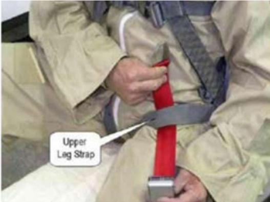
Figura 5. Pase el lazo de sujeción debajo de la banda de elevación principal
