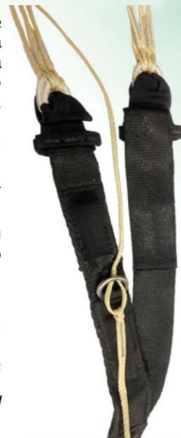
**Encontrar el punto óptimo:** Aquí, el ojal de bloqueo en las líneas de dirección está a la altura del anillo guía de la línea de dirección en el elevador.
