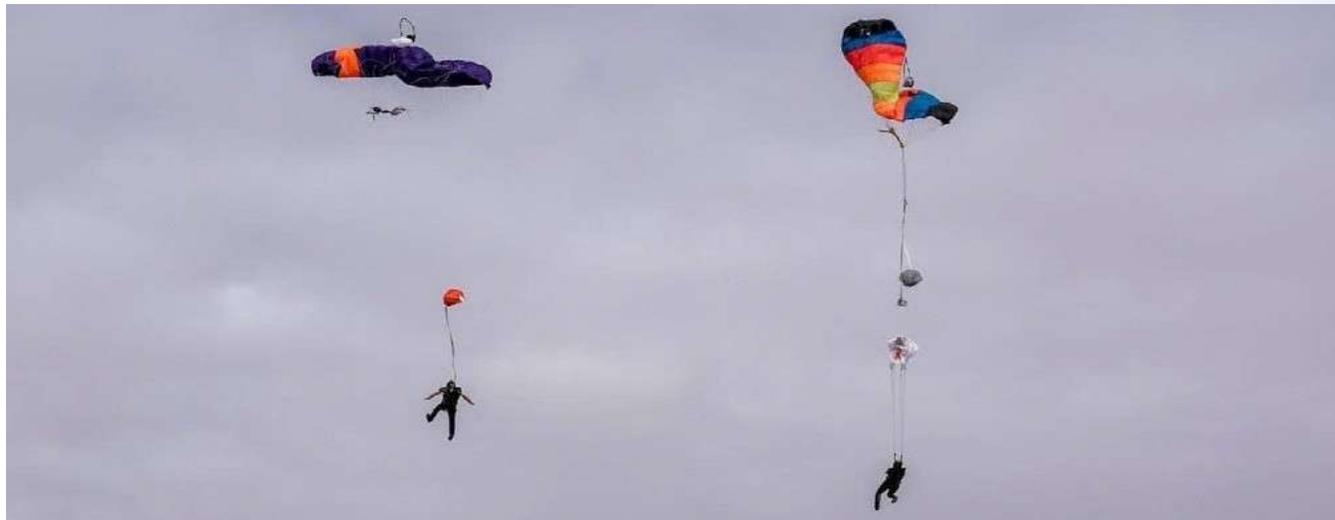
**Activación de la reserva RSL vs. RSL equipado con MARD:** Reserva activada mediante un RSL tradicional (izquierda) y un RSL equipado con MARD (derecha). Foto de Niklas Daniel, de la Escuela de Vuelo AXIS.
