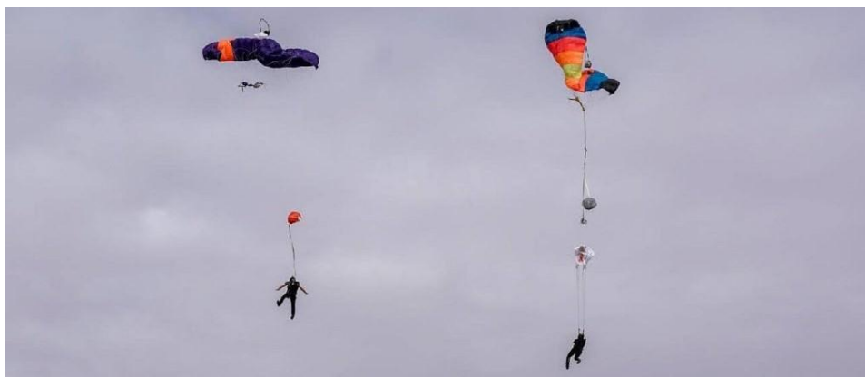
Activación de la reserva RSL vs. RSL equipado con MARD: Reserva activada mediante un RSL tradicional (izquierda) y un RSL equipado con MARD (derecha). Foto de Niklas Daniel, de la Escuela de Vuelo AXIS.
